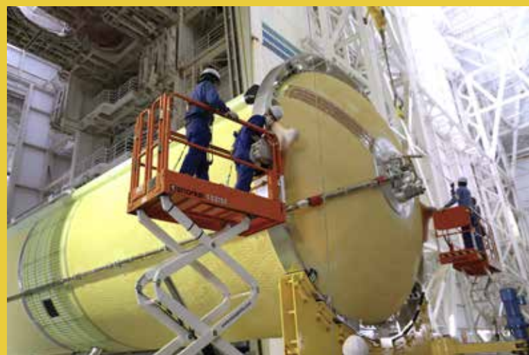
H3 ロケット3号機1段機体組立 ©JAXA
