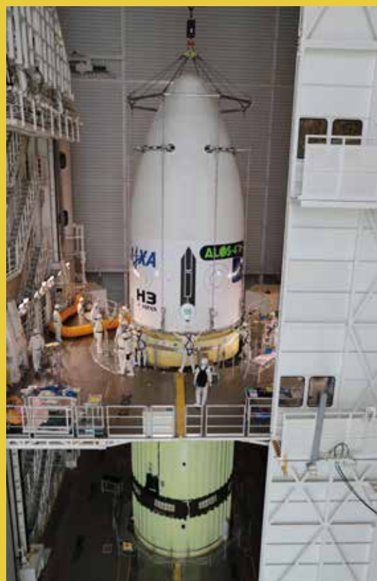
H3 ロケット3号機用フェアリング組立 ©JAXA
